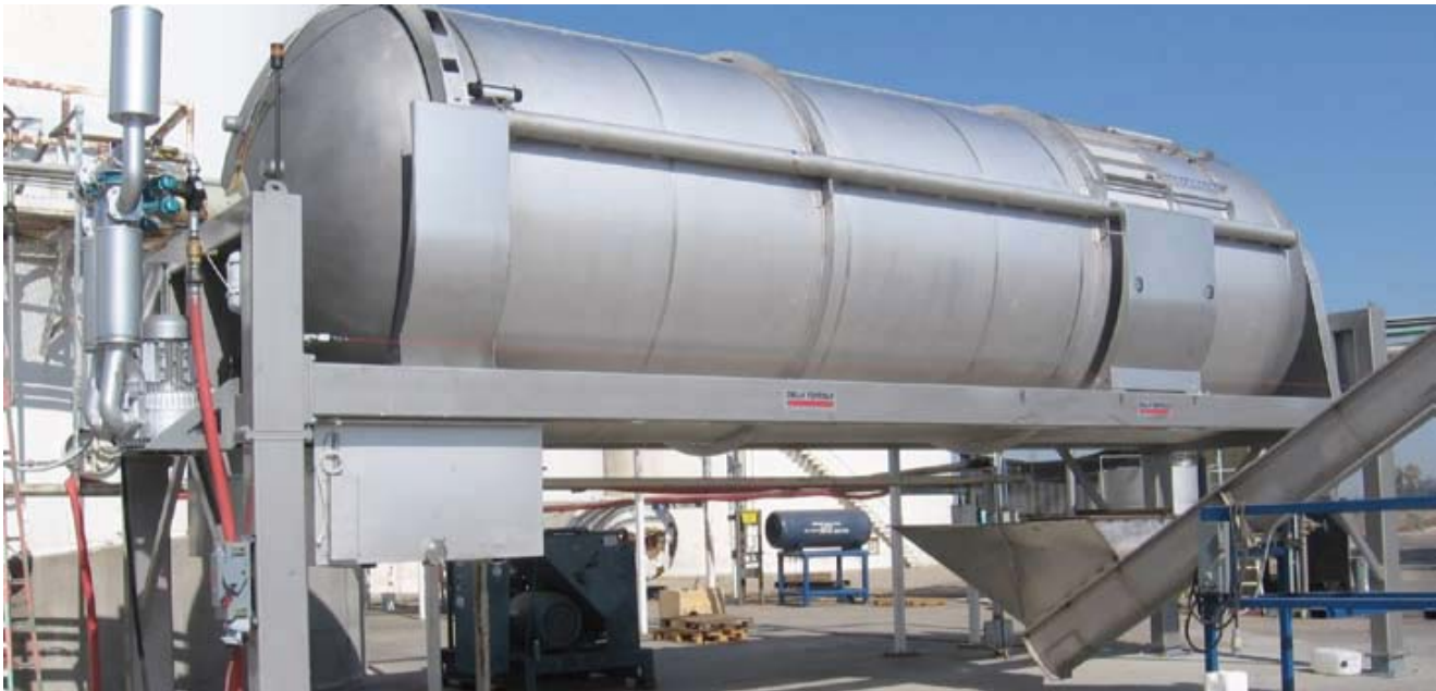
Fig. 2. The Della Toffola Central Membrane Air Bag Press.
